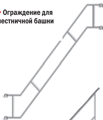
▶ Внутреннее ограждение для лестничной башни
